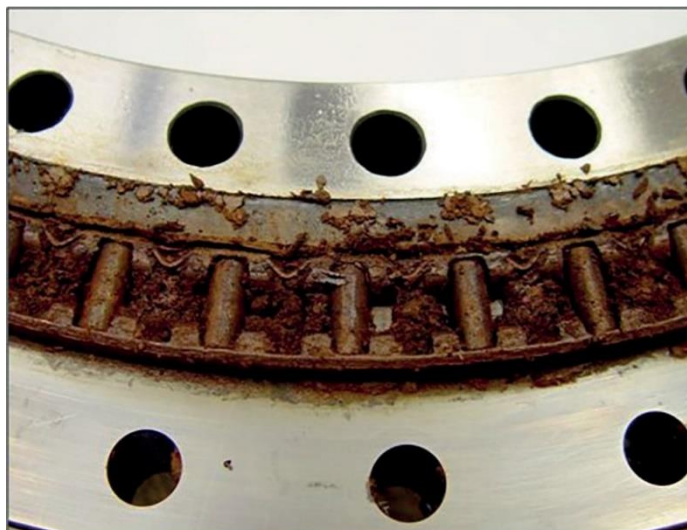
شکل ۱۴ – خوردگی ناشی از رطوبت بر روی محفظه و غلتک‌های یک یاتاقان سوزنی تراست
