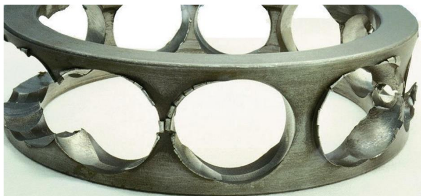
شکل ۹ - سایش ساینده پیشرفته در حفره‌های قفسه یک یاتاقان قفسه فلزی
