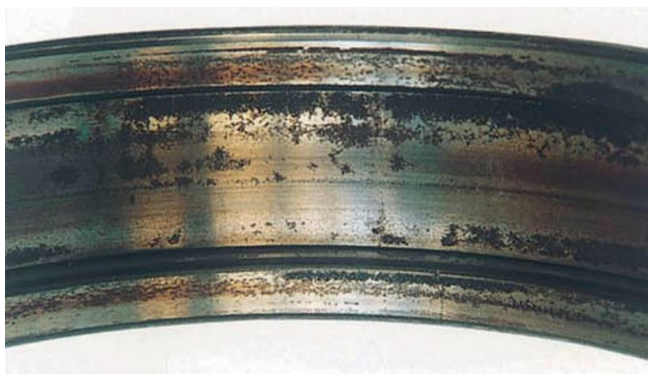
شکل ۱۵ – خوردگی ناشی از رطوبت بر روی سطح مسیر رینگ بیرونی یک یاتاقان غلتکی استوانه‌ای
