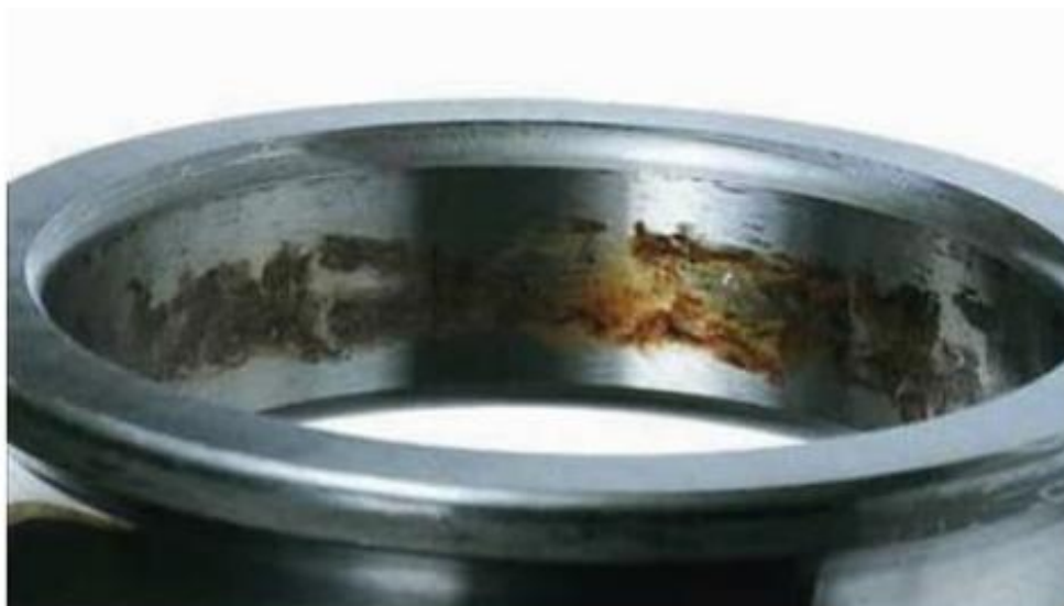
شکل ۱۷ - خوردگی سایشی در سطح داخلی رینگ درونی یک یاتاقان شیار عمیق
