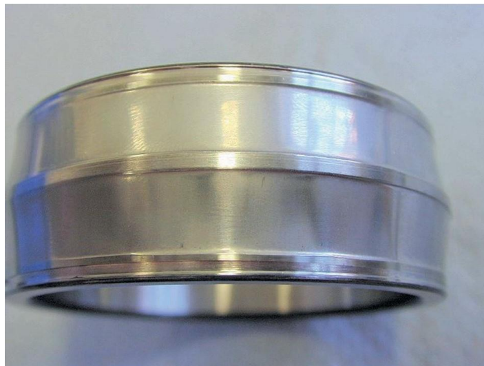
شکل ۸ – سایش ساییده روی رینگ داخلی یک یاتاقان غلتشی کروی
