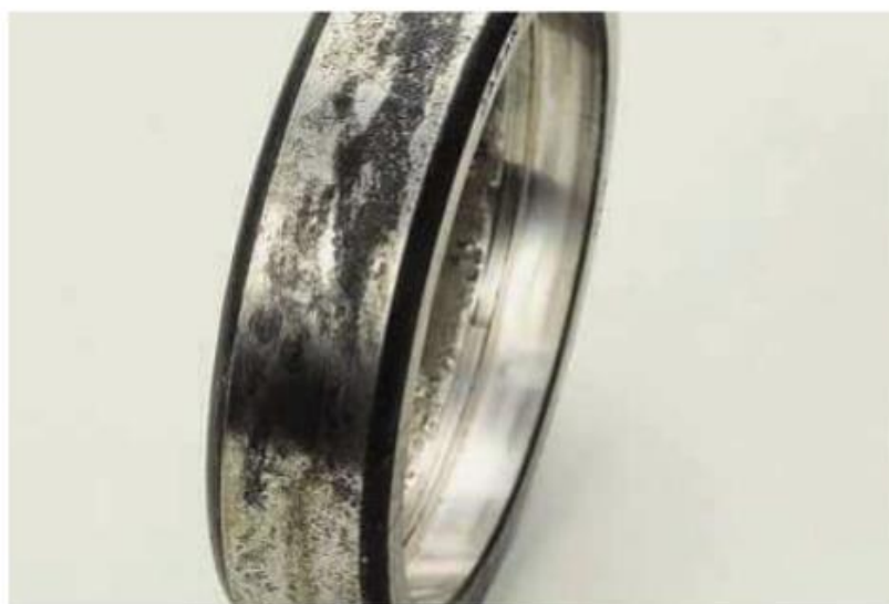
شکل ۱۸ - خوردگی سایشی روی قطر رینگ بیرونی یک یاتاقان غلتشی
