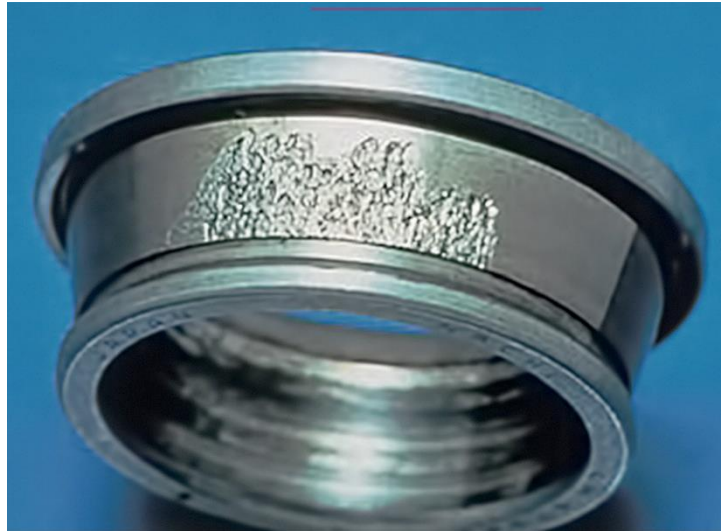
شکل ۴ - پوسته پوسته شدن پیشرفته زیر سطحی در یک یاتاقان غلتشی مخروطی - رینگ داخلی ثابت
