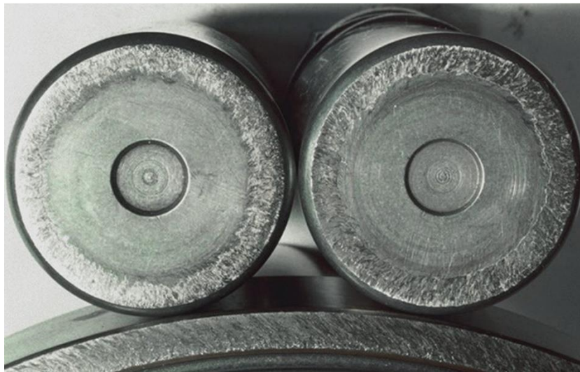
شکل ۱۳ – سایش چسبنده بر روی سطح جانبی غلتک‌های یک یاتاقان غلتشی استوانه‌ای
